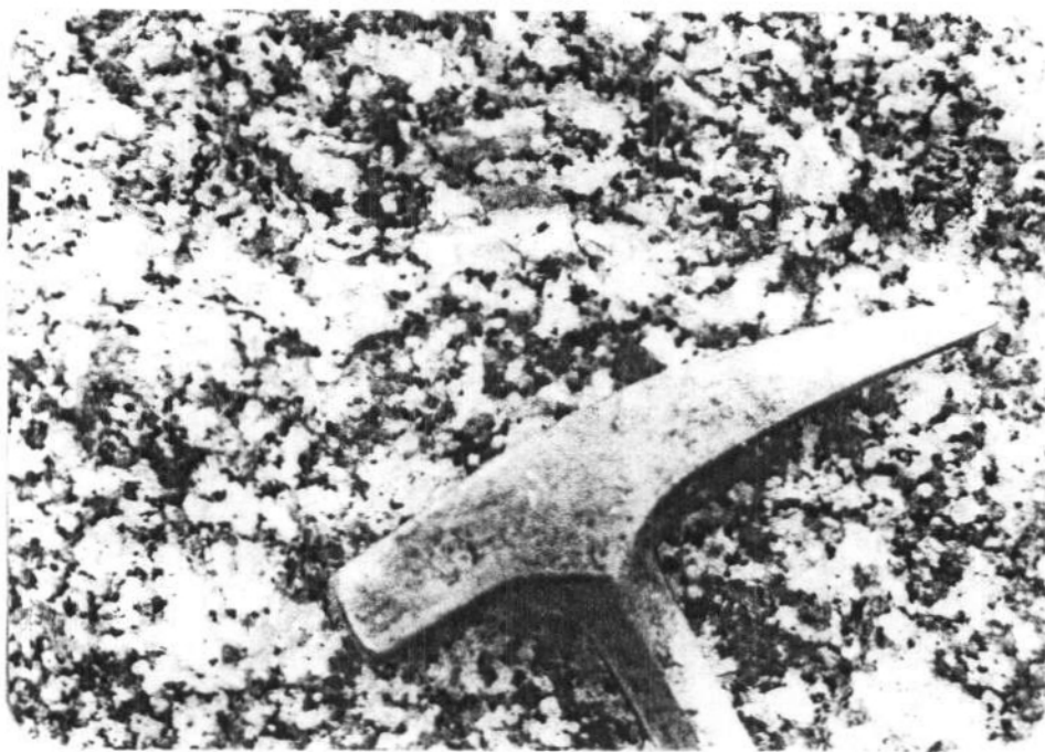
SIERRA DE OUTFIRO (LUGO). Granodiorita de Rozas. Roca granuda, con gruesos cristales de plagioclasa blancos, que le confieren un cierto matiz porfiroide. La zona está cubierta por un gruesa capa de alteración. La disyunción de esta granodiorita es en gruesas bolas. 2-2/AH-1.
