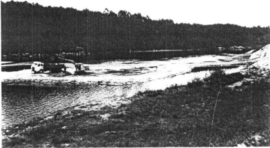
Aspecto de una explotación de gravas y arenas en el aluvial del Río Miño. El material se extrae del mismo cauce del río por dragado con una pala excavadora (Gravera Oleiros, junto a Salvatierra de Miño). Estación 2-3/RN-458.
