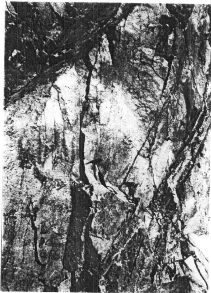
Detalle de la textura y diaclasado de la roca; se trata de un granito leucocrato de dos micas de grano fino a medio. Estación 2-3 RN-136.
