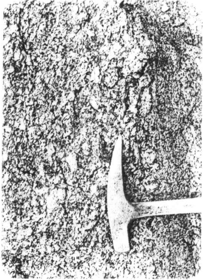
Granodiorita precóz de Parga. Cristales grandes de feldespatos calcosídrico y micas confieren a la roca una marcada orientación anisotrópica. La abundancia de biotita es manifiesta. 22. AH-8.
