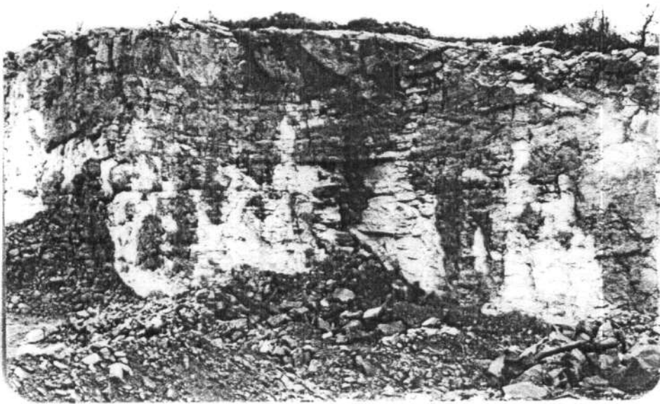
Otro aspecto del frente de extracción en la cantera de la caliza de Cándana, al NW de Meira. Alternan capas tableadas, con otras de potencia métrica o superior. 2-2/AH-2.
